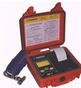
Registratore di *Pressione* Gastech instruments (IT) per effettuare collaudi conforme alla Norma **UNI 11149** - Tubazioni Polietilene per Acqua
