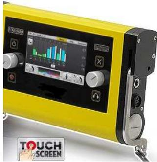
AquaLeak Digital GLD-6000 è un geofono digitale di ultima generazione.
