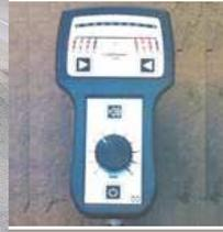
Aqua Leak Digital è un geofono digitale con una qualità acustica eccellente che permette di rilevare in modo accurato e rapido perdite d'acqua su tubazioni in pressione. I filtri selettivi permettono di eliminare rumori esterni.
