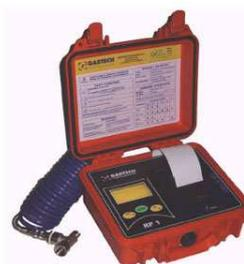
**Gastech instruments RP 1610** Permette veloci ed accurati Test di tenuta in Pressione con sensore esterno da 300 mbar degli scarichi e delle linee fognarie richiesti dalla norma **UNIEN 1610**.
