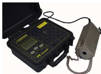
Cercatubi Gastech instruments (IT) per la localizzazione di tubazioni dell'Acqua in polietilene o plastica interrati, un impulso meccanico sulla tubazione ci permette di rilevare la tubazione con i classici sistemi di rilevazione acustici.
