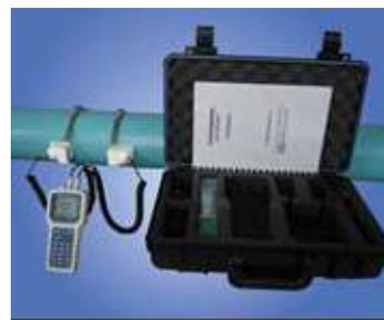
Flussometro ad ultrasuoni non intrusivo EESIFLO (GB) ideale per misure di portata in campo su tubazioni acqua, possibilità di memorizzare fino a 100.000 punti e scaricarli su PC per successive analisi
