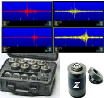
ZetaCorr FlowMetrix (USA) è un sistema di Multicorrelazione, posti sulla rete in una sola notte di acquisizione permettono di effettuare la correlazione incrociata tra tutti gli otto (8) sensori.
