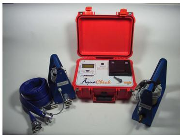
AquaCheck è uno strumento ideato da Gastech instruments (IT) che permette di effettuare la verifica dei contatori **Dn 25** con contatore interno soggetti di contestazione da parte dell'utente in modo semplice e veloce senza la necessità di smontare il contatore.
