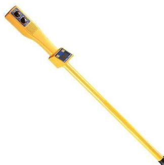
**Magnetometro** ha una capacità di rilevare oggetti metallici anche ad 1 mt di profondità, e di **rilevare le Aste delle Valvole interrate** dove il chiusino è stato rimosso.
